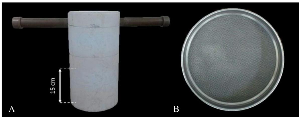
**Figura 2:** Amostrador cilíndrico utilizado para a coleta de material biológico (A) e peneira ISO 3310-1, de malha com 1 mm (B), utilizada na triagem dos organismos.
