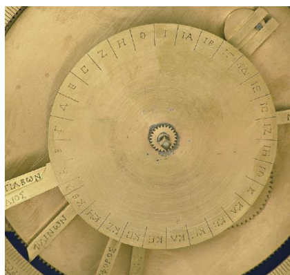
Figura 22. Engrenagem que transfere movimento para a engrenagem em forma de coroa, responsável pela rotação da esfera que representa as fases da Lua. WRIGHT, 2005.
