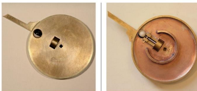
Figura 21. Indicador da fase da Lua: face externa à esquerda e interna à direita.
