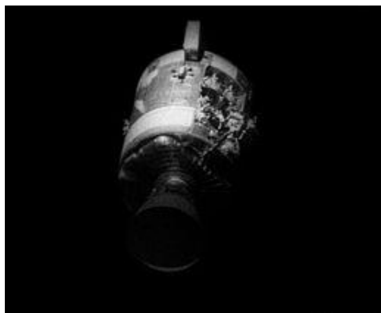
Figura 5. O danificado módulo de serviço da Apollo 13 depois de ser descartado.
