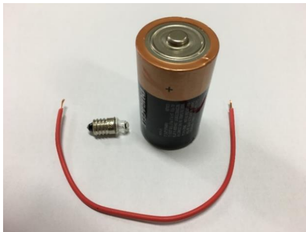
Figura 1: Materiais do experimento (pilha, lâmpada e fio)
